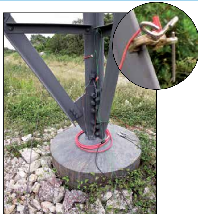
Med AmpFLEX™ strömspolar kan mätningar på alla masttyper göras, även vindkraftverk.
