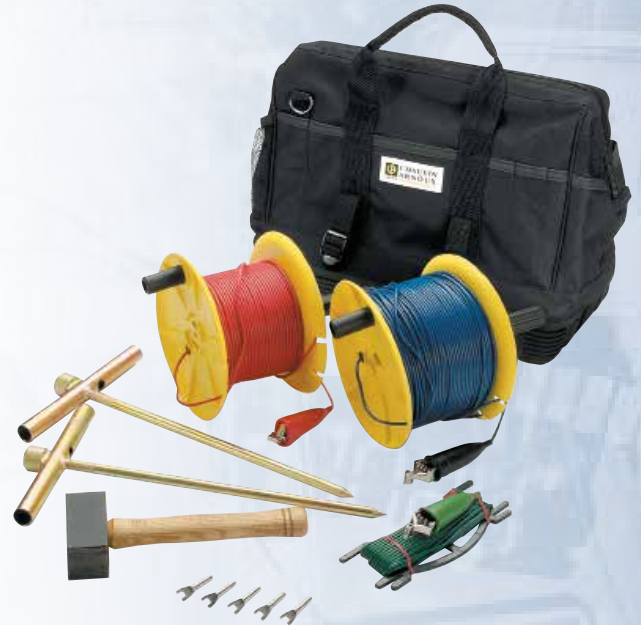
Jordtagssats P01102021: för mätning vid underhållsbesiktning med 3-trådsmetoden
