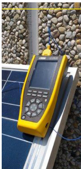
Temperaturmätning på solpaneler. Det praktiska Multifix-tillbehöret med magnet gör dem enkla att använda ute i fält.
