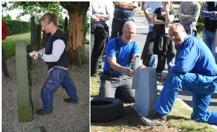
Figur 20 och 21. Mätning med tryck-/draginstrumentet. Här med tryck mot en hög resp en låg sten.
