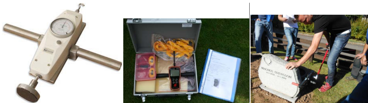
Figur 19. Tre gravstensinstrument. Till vänster FA-500 G från Elastocon AB, Brämhult, i mitten Sauturs instrument komplett i väska och med handledning på svenska, från SweTest, Saltsjö-Boo, Båda med tydlig display, tryckplatta och dragkrok och till höger det av Orax speciellt framtagna instrumentet för prövning av gravstenssäkerhet.
