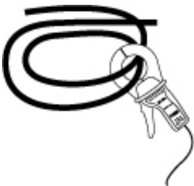
Figur 10. Ledaren kan lindas flera varv för noggrannare mätresultat
