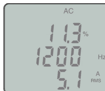
F407 skärm H3; överton 3 mäts på ett 400 Hz nätverk
