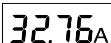
Om mätningen överskrider displaykapaciteten (400 A), visar displayen 399,9 blinkande.
